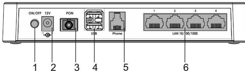
Рисунок 2 – Внешний вид задней панели NTU-RG-1421G-Wac, NTU-RG-1431G-Wac
