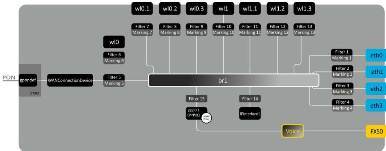
Рисунок 4 – Логическая архитектура устройства с заводской конфигурацией
