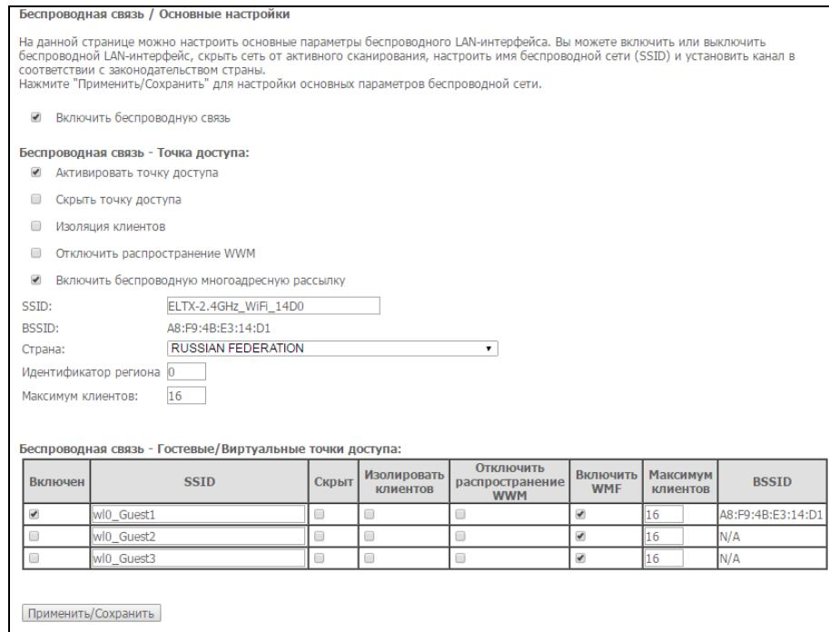
На данной странице можно настроить основные параметры беспроводного LAN-интерфейса. Вы можете включить или выключить беспроводной LAN-интерфейс, скрыть сеть от активного сканирования, настроить имя беспроводной сети (SSID) и установить канал в соответствии с законодательством страны. Нажмите "Применить/Сохранить" для настройки основных параметров беспроводной сети.
