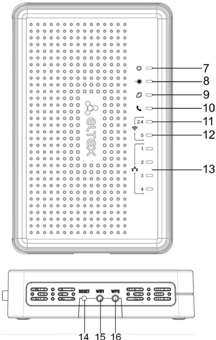
Рисунок 3 – Внешний вид боковой и верхней панели NTU-RG
