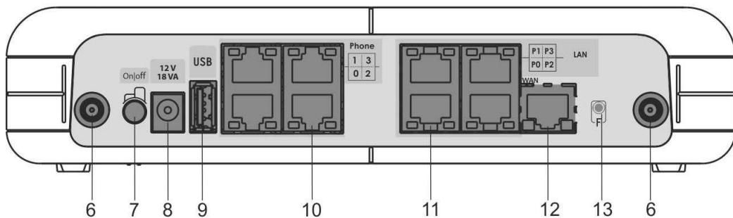
Рисунок 6 – Внешний вид задней панели RG-1404G-W.
