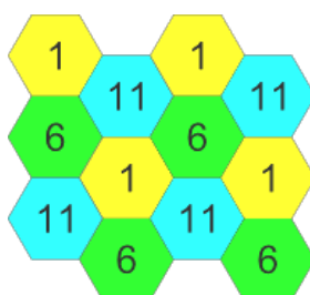
Рисунок 4 – Схема распределения каналов между соседними точками доступа в диапазоне 2.4 ГГц при ширине канала в 20 МГц
