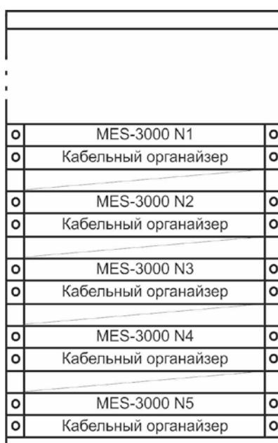
Рисунок 11 – Размещение коммутаторов MES-3000 в стойке
